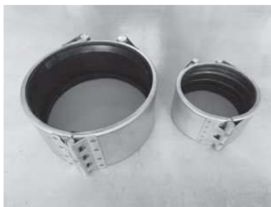
【ストラップクランプ】 \phi 100 \phi 150 \phi 200 \phi 250 \phi 300 〈用途〉配管の溶接部やピンホール 腐食割れした部分の漏水補修材
